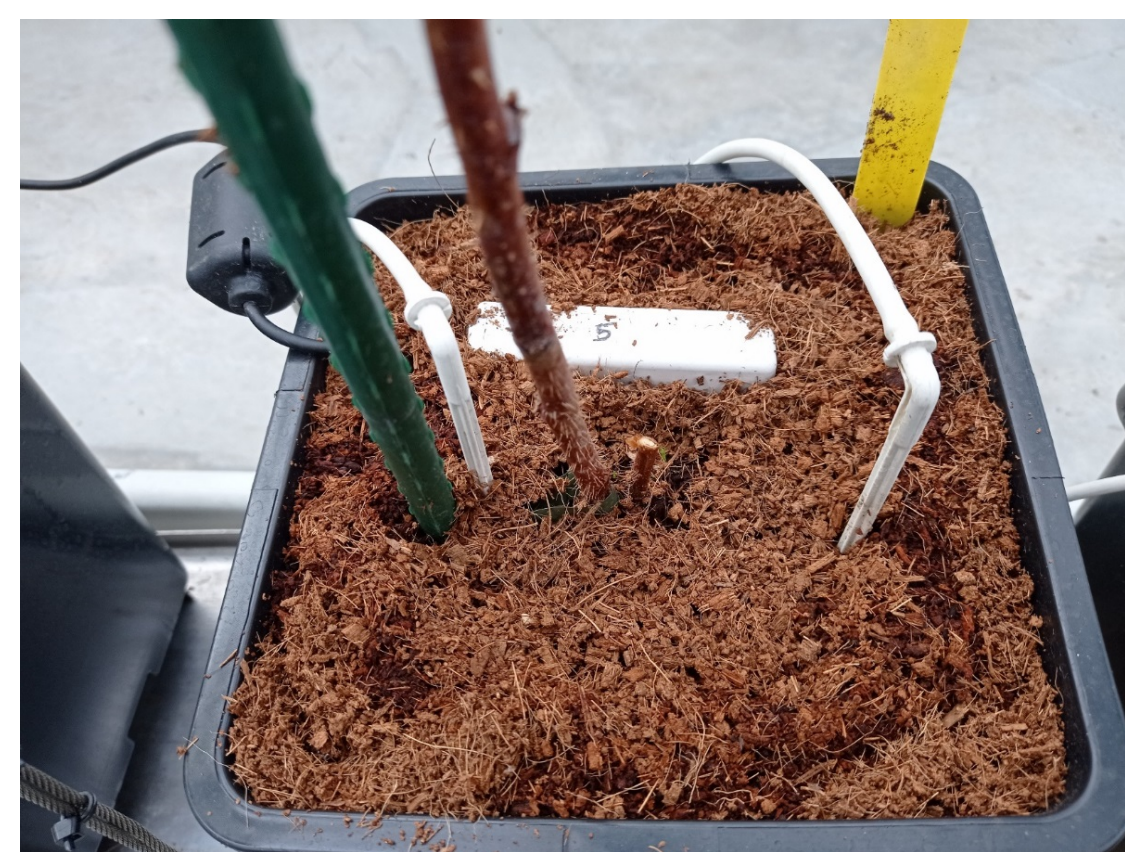
System monitorowania parametrów podłoża (wilgotność, EC, temperatura) i sterowania nawadnianiem
