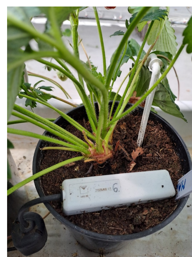
System monitorowania parametrów podłoża (wilgotność, EC, temperatura) i sterowania nawadnianiem
