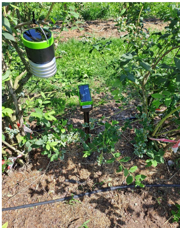
Bezprzewodowa sonda wilgotności, EC i temperatury gleby zamontowana na plantacji borówki (widoczna również stacja mierząca temperaturę i wilgotność powietrza)
