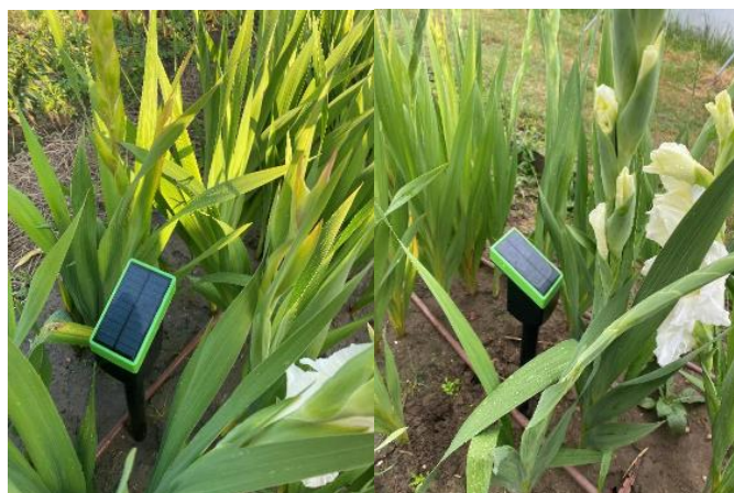
Fot. 1. Sondy AM-100 pozwalające monitorować w sposób ciągły temperaturę, wilgotność i zasolenie gleby.
