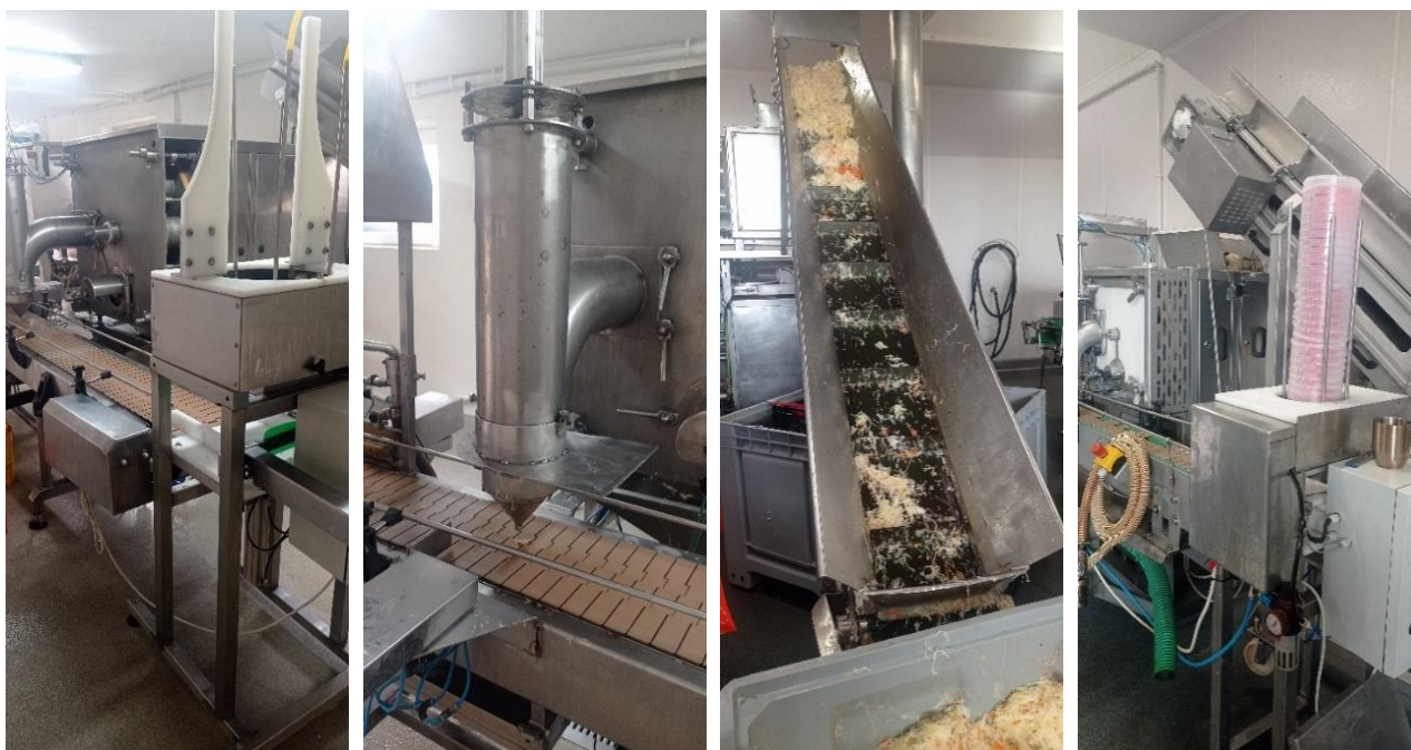
Zdjęcia 1. Elementy linii produkcyjnej odpowiadającej za transport, cięcie i pakowanie kapusty.
