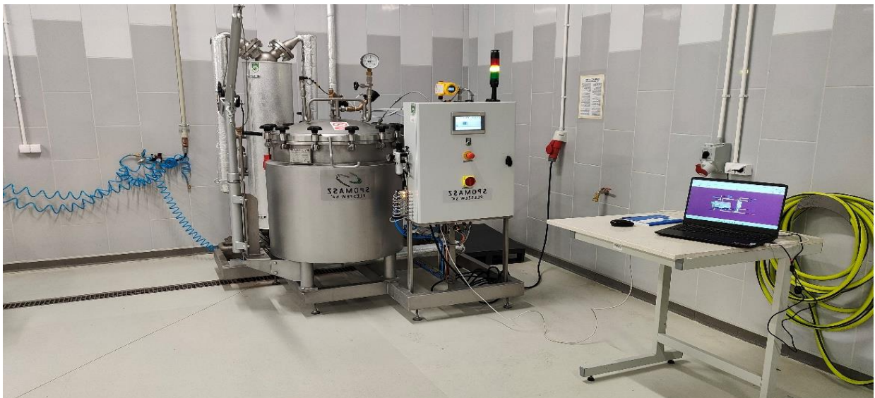
Fot. 2. Autoklaw z automatyzowaną kontrolą procesu sterylizacji.
