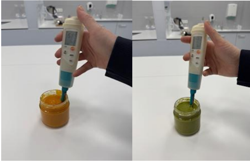
Fot. 8. Pomiar pH urządzeniem możliwym do wykorzystania w RHD.
